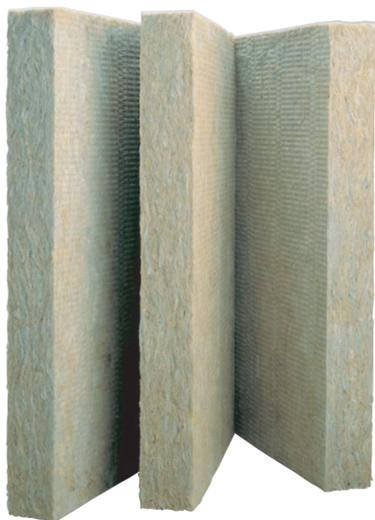
Жесткие гидрофобизированные теплоизоляционные плиты, изготовленные из каменной ваты на основе габбро-базальтовых пород. Плиты Rockwool Флор Баттс (рис. 40) предназначены для устройства акустических плавающих полов, а также для тепловой изоляции полов по грунту. Обладают динамическими характеристиками, отвечающими требованиям по защите от шума, и относятся к классу высоко эффективных звукоизоляционных прокладочных материалов.
